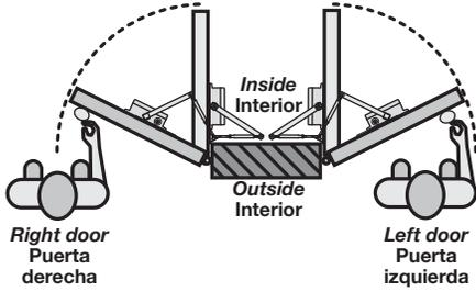
El sentido de apertura de las puertas se determina situándose en la parte exterior de la habitación de frente a la puerta y observando la posición de las bisagras, si las bisagras están colocadas en el lado derecho la puerta es derecha mientras que si están colocadas en el lado izquierdo, será puerta izquierda.
