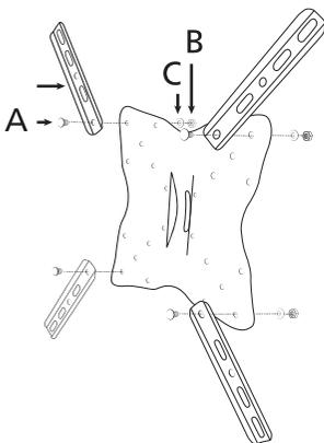
3. Fije el soporte en la pared utilizando los tornillos (K) y rondanas (K). *Attach the wall mount in the wall use the bolts (K) and washers (K).*
