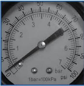
Manómetro con escala doble en PSI y BAR.
