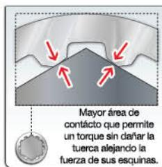
El mecanismo de las matracas está diseñado para trabajar con tornillos con cabeza:
