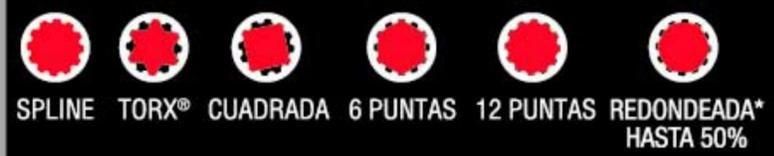
Una sola llave con geometría **SPLINE** puede sustituir hasta 3 llaves distintas.
